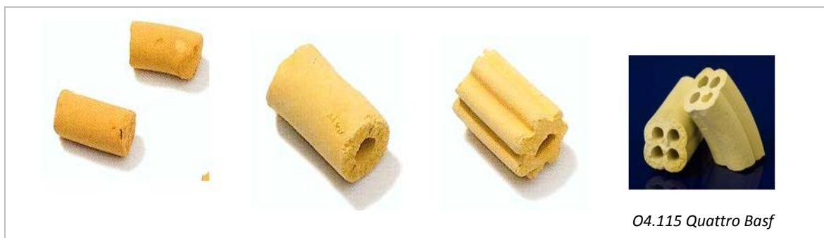
Fig. 4 - Modifica della morfologia del catalizzatore nel corso degli anni
