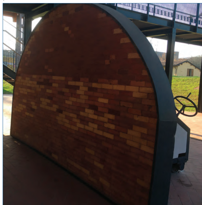
Fig. 3 - La paratoia refrattaria di chiusura del forno lineare ora parte del polo Navile dell’Università di Bologna
