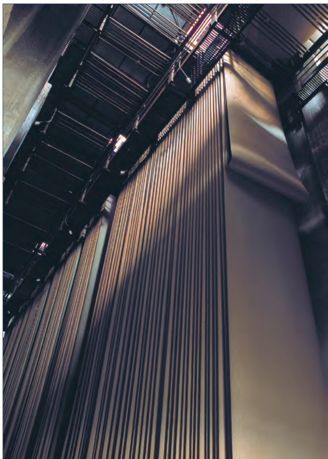
Fig. 5 - Linoleum nelle stufe
