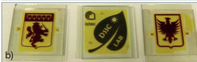
Fig. 2 - a) Schema di funzionamento e b) esempi di flessibilità di design di una cella sensibilizzata a colorante (DSSC)
