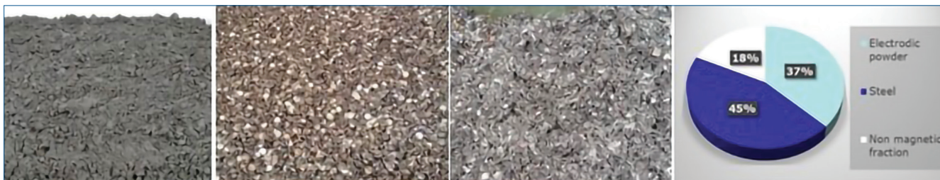
Fig. 8 - Frazioni recuperate da sx: polvere elettrodica, acciaio, carta e plastica; distribuzione delle frazioni
