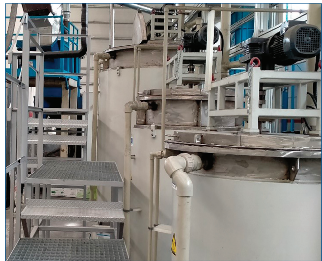
Fig. 7 - Impianto prototipo LiBat: sezione idrometallurgica
