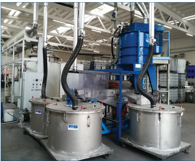
Fig. 6 - Impianto prototipo LiBat: sezione meccanica
