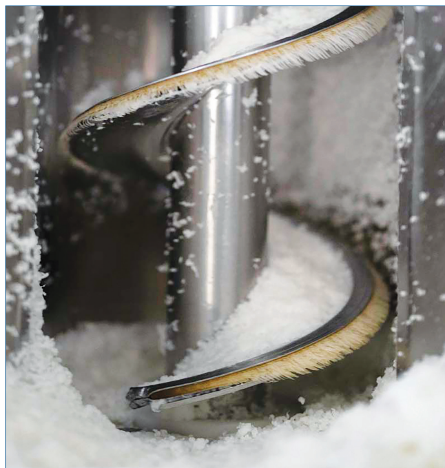
Fig. 2 - Estrazione della cellulosa d'agrumi atta alla filatura nell'impianto di produzione Orange Fiber
