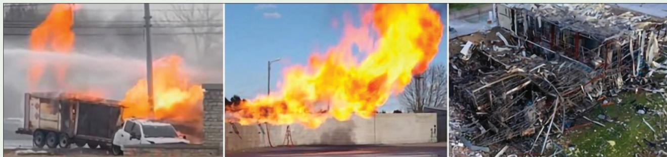
Fig. 2 - Scenari incidentali derivanti dall'utilizzo di idrogeno. Da sinistra verso destra: esplosione e conseguente incendio da fireball di un furgone trasportante idrogeno compresso, Ohio, USA (Credit: WBNS 10TV Columbus, Ohio); simulazione di jet fire da combustibile compresso; conseguenze di esplosione da idrogeno, AB Specialty Silicones, Illinois, USA (Credit: Chemical Safety Board)
